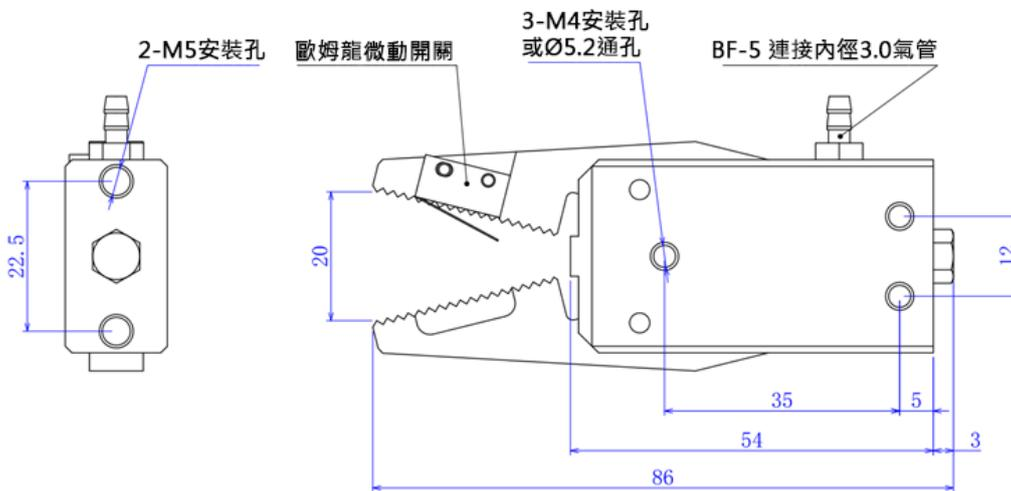
※M4 螺絲孔孔距 16mm · Ø5.2 通孔孔距 12mm · 接頭 BF-5、BF-6 可選
